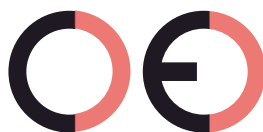
Marcatura CE contraffatta (troppo distante)
